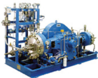
Рис. 14 Тип: Мембранный компрессор МКЗ450-10/280-25 Количество оборотов: 460 мин -1 Количество ступеней: 2 Газ: Высокоочищенный водород Давление на входе: 10-14 бар абс Конечное давление: 251 бар абс Мощность двигателя: 33 кВт Производительность: 142 м 3 /час Исполнение: Полностью готовый к эксплуатации
