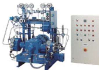
Рис. 15 Тип: Мембранный компрессор МКЗ185-5/120-15 Количество оборотов: 720 мин -1 Количество ступеней: 2 Газ: водород Давление на входе: 5 бар абс Конечное давление: 151 бар абс Мощность двигателя: 2,6 кВт Производительность: 5,5 м 3 /час Исполнение: Полностью готовый к эксплуатации
