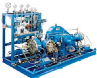
Рис. 18 Тип: Мембранный компрессор МКЗ280-10/185-25/120-100 Количество оборотов: 400 мин -1 Количество ступеней: 3 Газ: водород Давление на входе: 8 бар абс Конечное давление: 801 бар абс Мощность двигателя: 11 кВт Производительность: 20 м 3 /час Исполнение: Полностью готовый к эксплуатации
