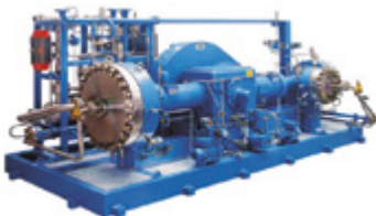
Рис. 16 Тип: Мембранный компрессор МКЗ280-5/470-10/315-25 Количество оборотов: 360 мин -1 Количество ступеней: 3 Газ: Высокоочищенный водород Давление на входе: 5 бар абс Конечное давление: 201 бар абс Мощность двигателя: 68 кВт Производительность: 250 м 3 /час Исполнение: Полностью готовый к эксплуатации
