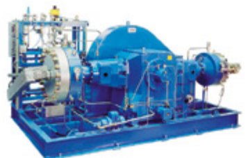
Рис. 19 Тип: Мембранный компрессор МКЗ680-10/450-40 Количество оборотов: 360 мин -1 Количество ступеней: 2 Газ: водород Давление на входе: 18 бар абс Конечное давление: 281 бар абс Мощность двигателя: 135 кВт Производительность: 580 м 3 /час Исполнение: Полностью готовый к эксплуатации
