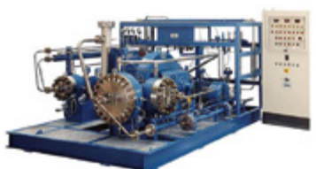
Рис. 17 Тип: Мембранный компрессор МКЗ200-70 2 Компрессора (компрессор и бустер) установленные на общей раме Количество оборотов: 380/350 мин -1 Количество ступеней: 3 Газ: Смесь аргона и кислорода Давление на входе: 8,3 бар абс Конечное давление: 621 бар абс Мощность двигателя: 44/14,7 кВт Производительность: 142 м 3 /час Исполнение: Полностью готовый к эксплуатации
